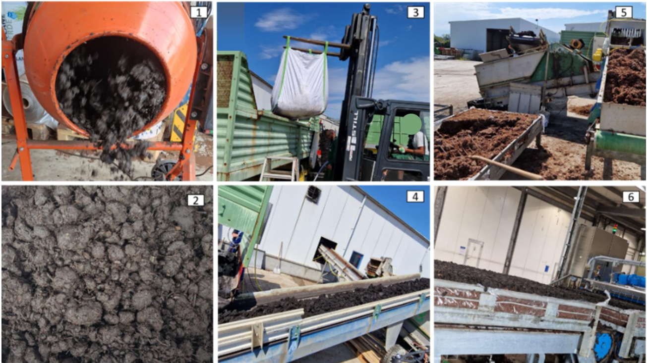
Abbildung 33: Herstellung der Mischung MD 50 (1 und 2) bei LAV und die Bereitstellung der Abdeckerden (3 und 4) und Substrate (5) sowie die Belegung der Kisten mit Substraten (6) beim Transferpartner Pilzhof Pilzsubstrat Wallhausen (IHD)
