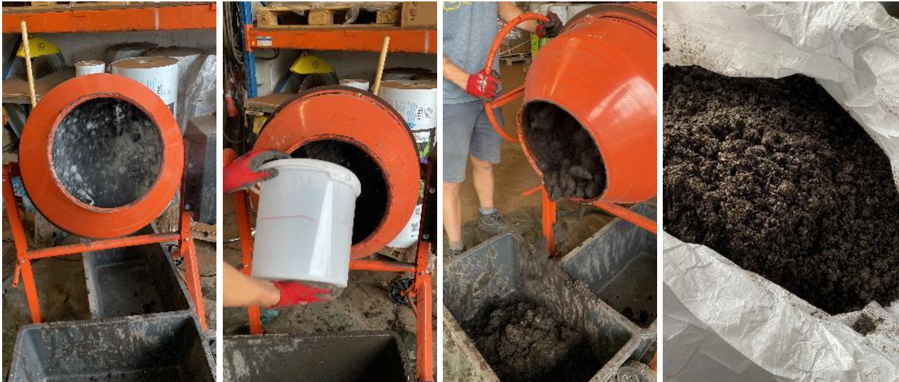
Abbildung 32: Herstellung von Mischungen für torffreie Abdeckerden mit Hilfe eines Trommelmischers (LAV)
