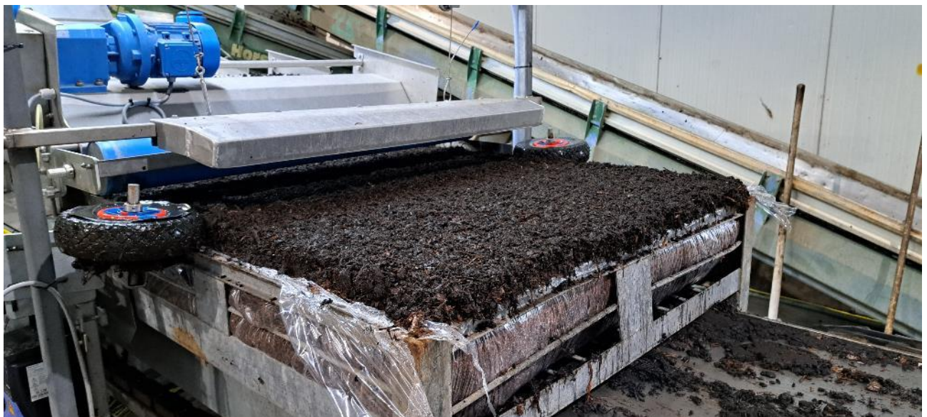
Abbildung 62: automatische Belegung der Kisten mit torffreier Abdeckerde im Pilzhof Walldhausen (LAV)
