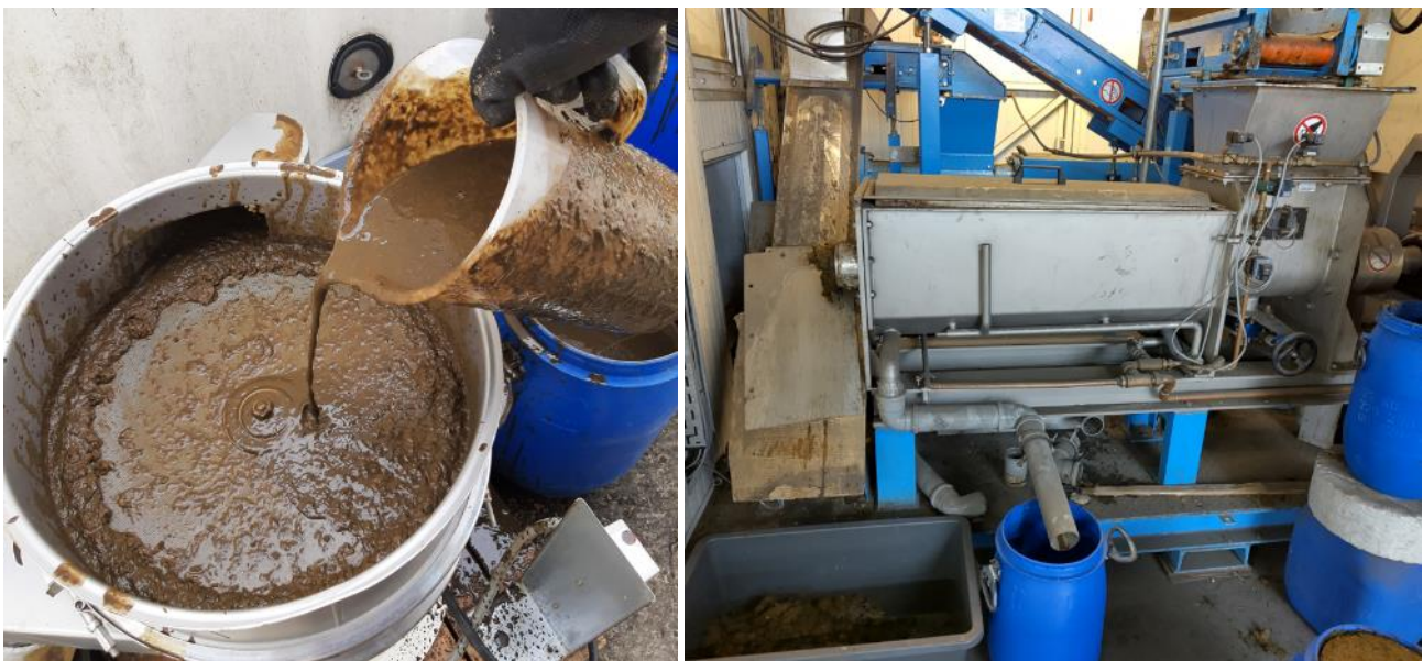
Abbildung 13: Separation und Waschung von Gärrestfasern (links), Entwässerung gewaschene Gärrestfasern mit Schneckenpresse (rechts) (IKTS)
